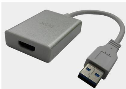
El adaptador compacto USB 3.0 a HDMI, convierte un puerto USB 3.0 en un puerto de salida HDMI con soporte para video de 1920x1200/1080p. Al funcionar como una tarjeta de video externa, este adaptador USB a HDMI ofrece una manera práctica de añadir capacidad multimonitor a un PC de escritorio o portátil con puerto USB 3.0 disponible (rendimiento óptimo con USB 3.0, retrocompatible con USB 2.0).
